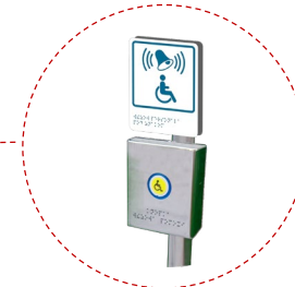
Проводное устройство двухсторонней связи с выводом сигнала на регистратуру. (Высота размещения 1100мм, стойка из нержавеющей стали)
