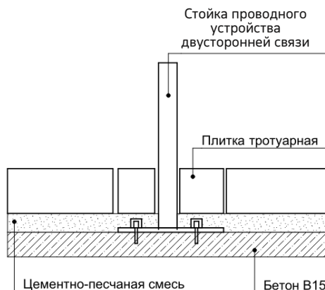
Устройство стойки в плиточном мощении
